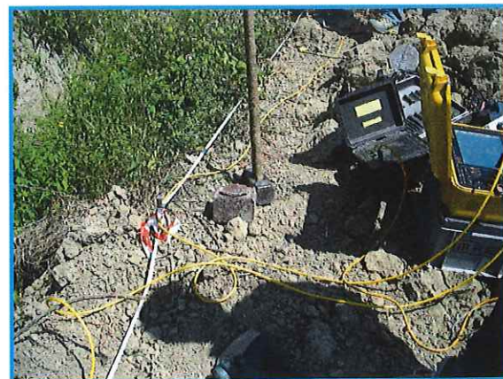
Fig. 6 – Sorgente energizzante, costituita da massa di 10kg che impatta verticalmente una piastra di alluminio. Come starter/trigger è stato utilizzato un geofono verticale Geospace a 14Hz.
