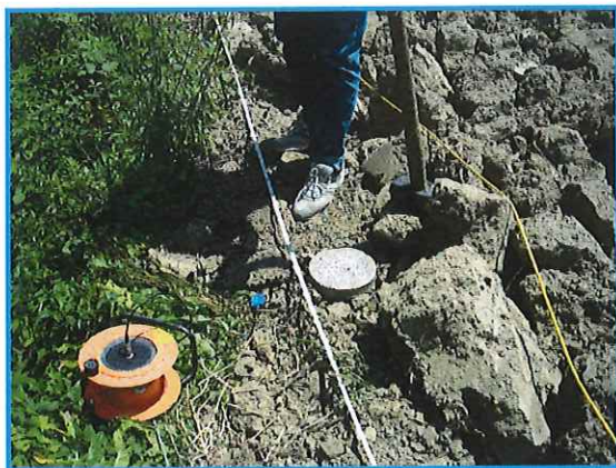
Fig. 6 – Sorgente energizzante, costituita da massa di 10kg che impatta verticalmente una piastra di alluminio. Come starter/trigger è stato utilizzato un geofono verticale Geospace a 14Hz.
